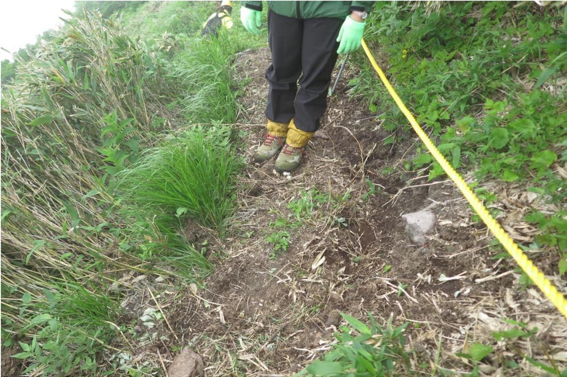
図2 南東落ちの開口段差亀裂(10~30cm 程度)
